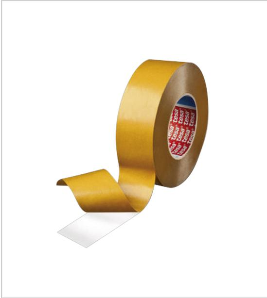
Adhésif double face transparent composé d'un support polypropylène et d'une masse adhésive en caoutchouc synthétique sans solvant pour la fixation de matériaux de décoration, d'emballage et le collage de films, tissus, papier et plastique épaisseur totale : 90 'b5m.
