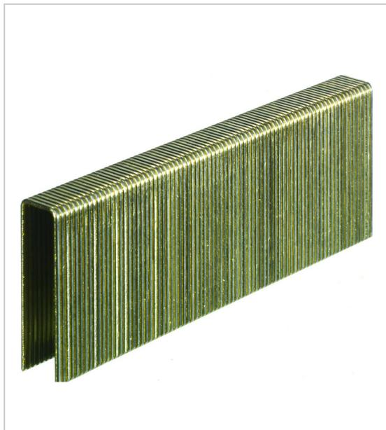
Agrafe moyenne M (ou SM50) idéale pour les travaux d'assemblage, d'encadrement, d'agencement, l'agrafage des dos de meubles, des caisses légères, l'assemblage de panneaux... pour cloueur HNS5015P finition : pointe cisailée résinée longueur : 12-38 mm largeur agrafe : 9,53 - 10,8 mm section du fil : 1,07 x 1,23 mm largeur de dos : 10,2 mm 80 agrafes par bande environ.
