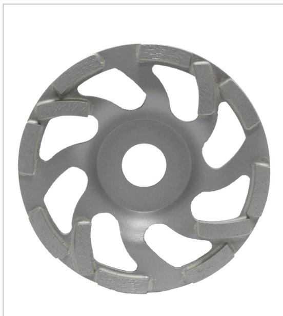
Plateau diamant pour ponçage du béton et époxy segments diamant "L" en biais pour une finition parfaite trous de dimension importante pour une meilleure évacuation des poussières, ponçage rapide, longue durée de vie.
