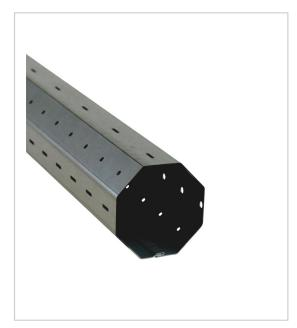
Axe octogonal de 60mm, en acier zingué épaisseur 0,6mm avec divers trous et lumières pour attaches souples et rigides
