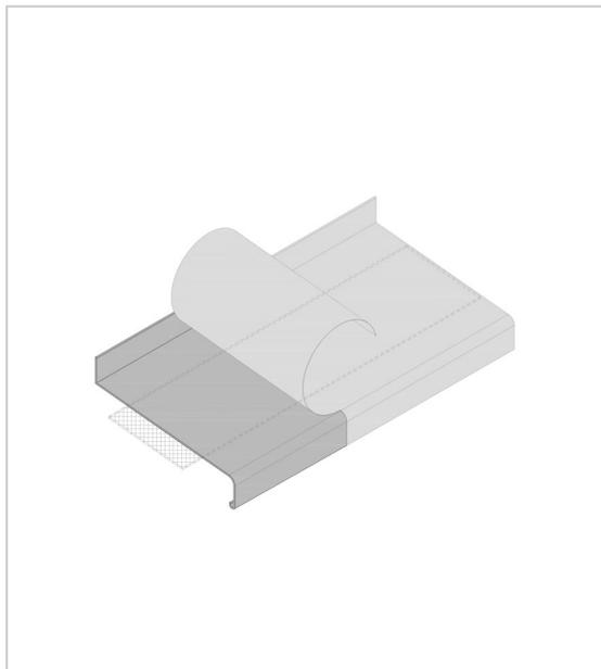
Bandes adhésives en élastomère adhésives 1 face appliquées sur la surface inférieure des tablettes de fenêtres, elles évitent la résonance provoquée par la pluie battante.
