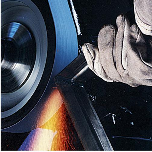
Support mélange coton-polyester semi flexible, très résistant XY abrasif zirconium à haut rendement distribution granulométrique fermée très résistante au déchirement et haut pouvoir de coupe support imperméable résistant aux lubrifiants et aux émulsions recommandé tout spécialement pour l'acier inox pour enlèvement des bavures, ébavurage des cordons de soudure, dégrossissage de pièces acier, inox, métaux non ferreux et fonte y compris cylindriques. boîte de 10.
