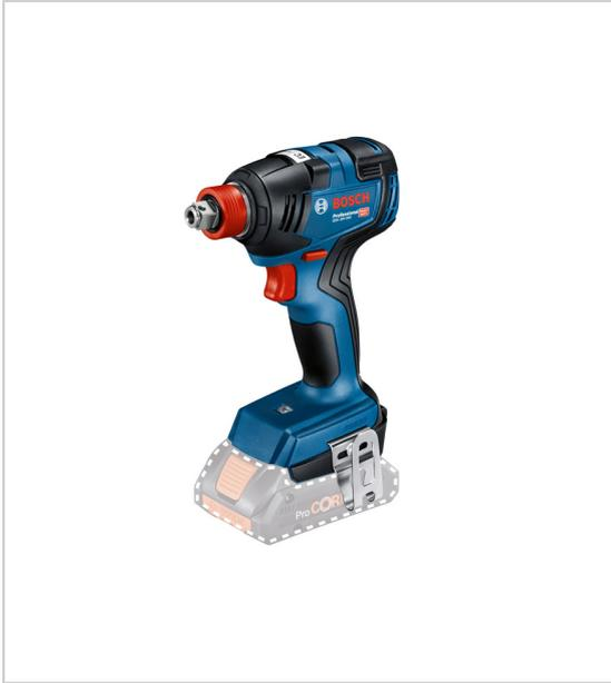
Moteur Brushless sans charbon porte-outil 2 en 1 permettant de commuter rapidement entre outil à six pans creux 1/4" et outil à carré mâle 1/2" dosage précis de la vitesse et du couple grâce à la gâchette de vitesse éclairage LED intégré crochet ceinture Ø vis M6-M16 livrée en coffret L-BOXX sans batterie, ni chargeur.
