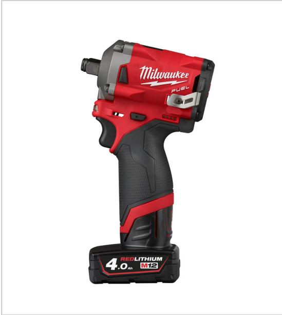
Moteur Brushless sans charbon carré 1/2" pour un changement facile et rapide des douilles protection contre les surcharges et les surchauffes capacité boulon max : M16 livrée en coffret HD Box avec 1 batterie Li-Ion 12 V 4 Ah, 1 batterie Li-Ion 12V 2 Ah, chargeur.
