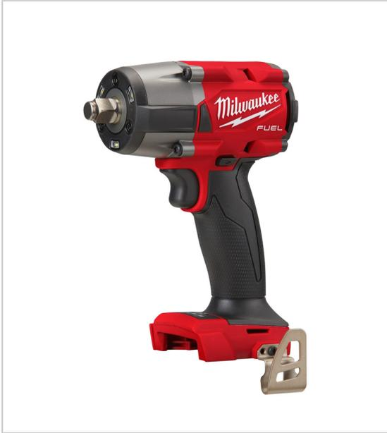
Moteur Brushless sans charbon 4 réglages de couple et vitesses différents la fonction extraction de boulon permet d'avoir le couple maximum puis le régime se réduit lorsque le boulon est desserré afin d'éviter la chute du boulon ou tout endommagement de matière le mode d'arrêt automatique n'applique pas plus de 47 Nm de couple pour les applications de serrage à la main afin d'éviter un serrage excessif livrée en coffret HD Box sans batterie, ni chargeur.
