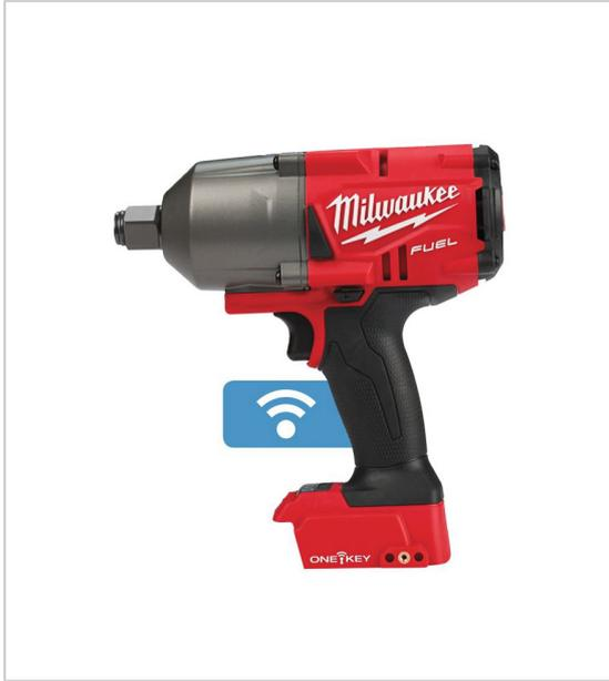
Moteur Brushless sans charbon DRIVE CONTROL 4 modes pour adapter le couple, la vitesse et la cadence selon les applications mode 4 idéal pour retirer les écrous électronique REDLINK PLUS offrant une protection contre les surcharges de l'outil et de la batterie technologie ONE-KEY pour suivre et sécurisé vos outils livrée en coffret HD Box sans batterie, ni chargeur.
