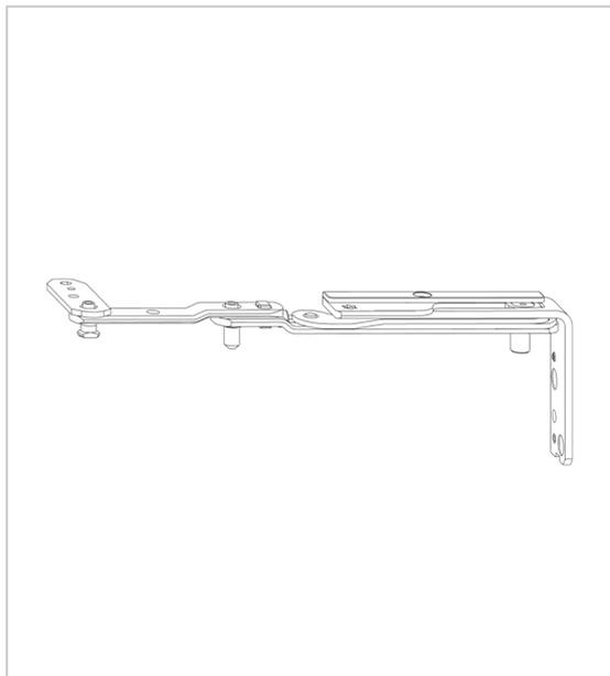
Bras de faux compas pour OF/Semi-fixe, ferrure Roto NT, système DESIGNO II pour menuiseries PVC.
