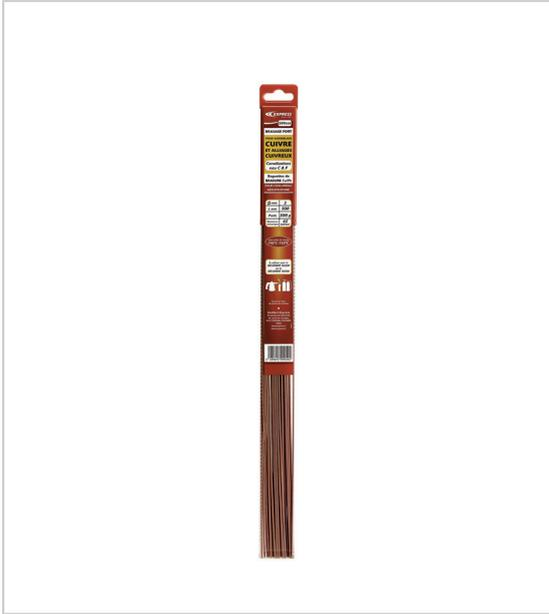
Baguettes de brasure Cu/Ph pour assemblages cuivre et alliages cuivreux et chalumeau aéropropane assemblage : cuivre et alliages cuivreux utilisation : canalisations eau chaude / eau froide température de fusion (°C) : 710 - 750 résistance mécanique (daN/mm) : 45 teneur en phosphore : 7,8% produit associé : décapant 105200 ou 105100.
