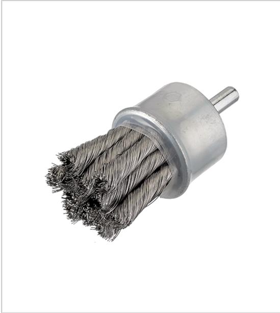
Ces brosses se caractérisent par leur efficacité et leur flexibilité. Grâce à la force centrifuge créée par la vitesse de rotation, la brosse s'ouvre et se ferme dès l'arrêt de la rotation. Pour cardage, ébavurage, enlèvement de laque et de scories, détartrage, dépolissage, nettoyage. Parfaitement adaptées pour le nettoyage d'alésage.
