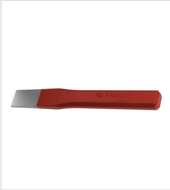
Burin à profil constant forgé dans des aciers au chrome-vanadium traité pour 57 HRc sur tranchant réaffûtable à la meule finition laquée.
