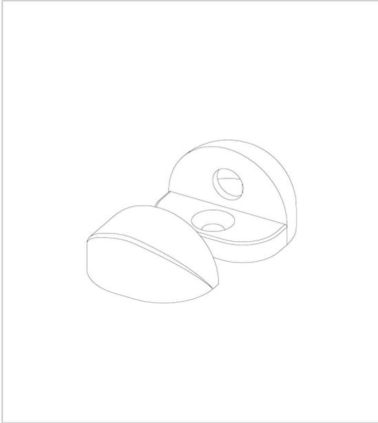
Butée pour couissant simple, y compris l'élément en caoutchouc
