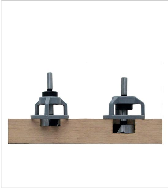
4 douille guide pour mèches Ø 15-50 pour le perçage de trous borgnes avec mèches Forstner et Wave Cutter butée de profondeur débrayable en PVC roulement à billes intégré et centreurs interchangeable en acier permet un perçage à profondeur précise et constante pince de montage incluse.
