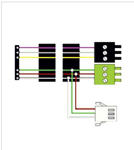
Câble pré-confectionné avec connecteurs pour liaison avec jonction de câble, verrouillage multipoints Eneo et système de contrôle d'accès.
