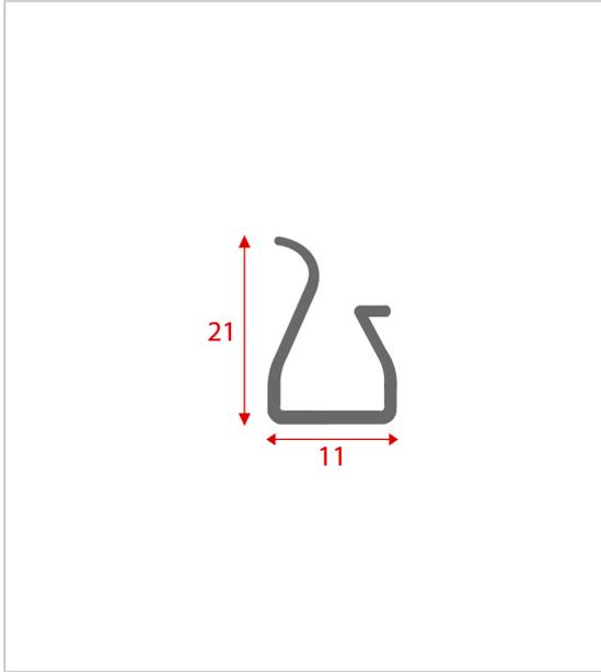
Cale en PVC à clipper pour protéger l'aile du dormant rénovation durant le transport.
