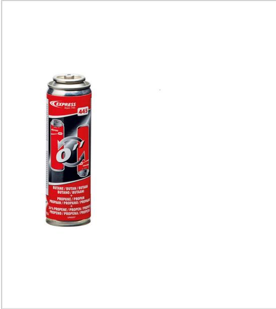
Mélange d'hydrocarbure : (26% propylène + butane + propane (60g) cartouche de gaz à mousse pour retournement immédiat conçue pour les fers de couvreur Réf. 364, et les fers de couvreur Réf. 6364 ainsi que le pistolet air chaud Réf. 4600 valve à vis au standard européen 7/16" - 28 filets au pouce (60°) poids : 60 gr (110 ml) conforme à la norme EN417. Utilisation « toute saison » jusqu'à - 13 °C
