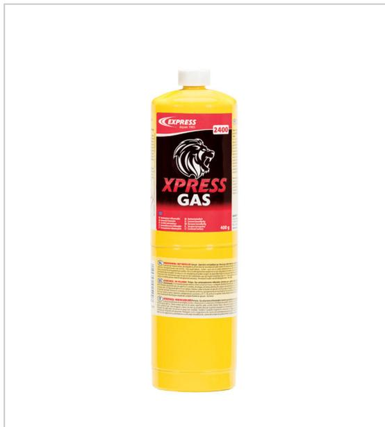
Gaz propylène boîtier acier 1L avec soupape de sécurité valve à vis au standard américain (1" - 20 filets au pouce (60°) utilisation en toutes saisons entre -20°C et + 49°C cartouche jetable non rechargeable recyclable étudiée pour être utilisée avec le chalumeau gaz Vulcane Express Réf. 470 et Réf. 472, Réf. 480, Réf. 481, Réf. 490, Réf. 491, Réf. 473, Réf. 478, Réf. 485, Réf. 486, Réf. 496 masse de gaz net : 450 gr.
