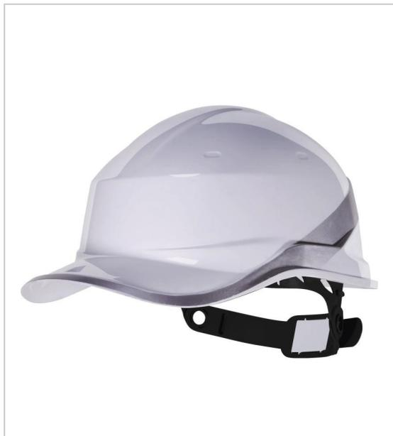
Casque de chantier forme baseball en ABS qui donne une vision verticale plus importante testé avec visière portée devant ou derrière, pour moins d'encombrement coiffe polyamide : 3 bandeaux textiles avec 8 points de fixation basane éponge, système de serrage ergonomique One-D Rotor pour un ajustement d'une seule main avec ou sans gants ajustable de 53 à 63 cm bande réfléchissante isolement électrique jusqu'à 1000VAC ou 1500VCC poids : 404 gr.
