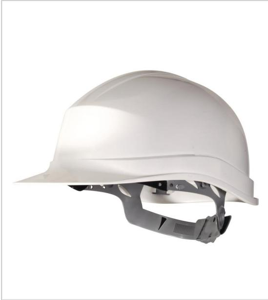
En polypropylène, traité anti-UV coiffe polyéthylène BD (LDPE), avec 8 points de fixation basane éponge serrage glissière ajustable : tour de tête 53 à 63 cm trou standard pour accessoires ancrages pour jugulaire à 2 ou 4 points isolement électrique jusqu'à 1000VAC ou 1500VCC poids : 345 gr.
