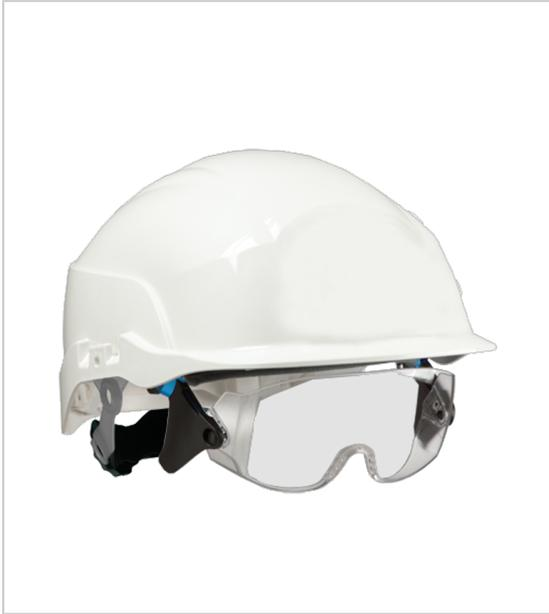
Calotte ABS coiffe toile térylène, 6 points d'ancrage tour de tête LDPE (polyéthylène basse densité) bandeau anti-transpirant Dry-Tech (polyester) crémaillère Acétal avec sangles HDPE, mousse noire 3 mm surlunettes : Polycarbonate moulé (revêtement anti-écaflures et anti-buée) visière courte (20 mm) taille : 52 - 64 mm poids : 484 gr.
