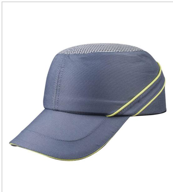
Casquette anti-heurt type base-ball, en textile polyester/enduit polyuréthane très aérée, partie supérieur en maille mesh, équipée d'une coque interne en polyéthylène et d'une mousse confort en EVA pour amortir les chocs taille unique réglable par boucle de 55 à 62 cm.
