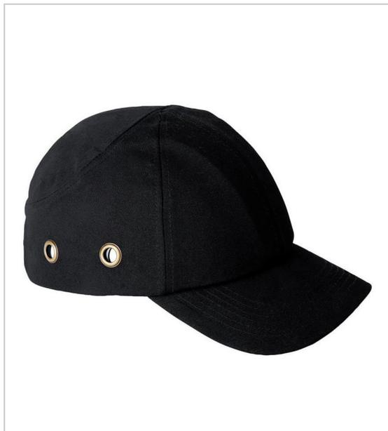
Casquette munie d'une coque en plastique protégeant contre les heurts. S'utilise surtout en intérieur où les chutes d'objet ne peuvent pas se produire. Tissus ext. : 100% coton, 255-265g/m<sup>2</sup> Coque de protection ABS Coussinets ext. en EVA Coussinets intérieurs en polyéthylène Anneaux d'aération cuivre. Ne protège pas contre les chutes d'objets (voir les casques de chantier pour l'industrie conformes à la norme EN 397).
