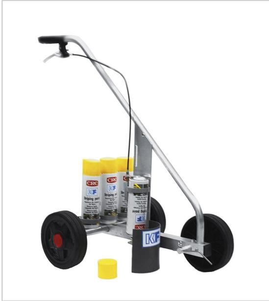
Servant à appliquer les peintures de traçage de ligne pratique et maniable, conçu pour une application et un entretien facile largeur de ligne ajustable de 4 à 10 cm marquage précis dû à la buse adaptée.
