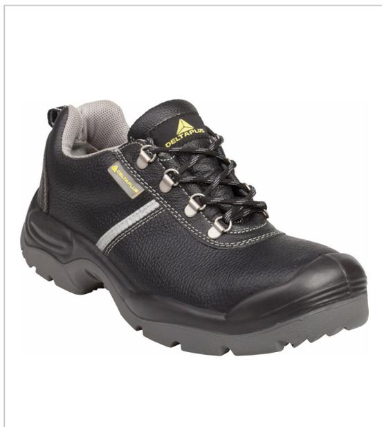
Tige en cuir croupon pigmenté munie d'une bande rétro-réfléchissante, doublure polyamide semelle anti-perforation et embout acier première de propreté préformée amovible dessus polyamide sur EVA semelle PU double densité à crampons avec nez enveloppant talon absorbeur d'énergie crampons grimpeurs à l'avant et stoppeurs à l'arrière accroches latérales pour échelle zones de flexions intégrées (système PANOFLEX®) moins de fatigue en fin de journée marche plus confortable.
