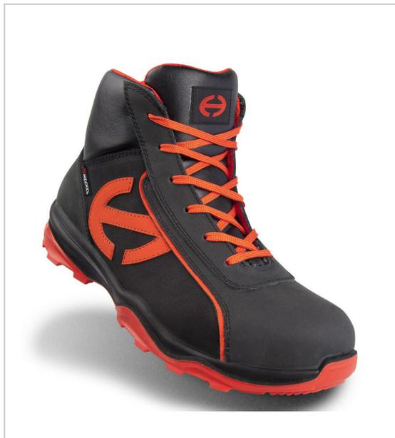
Tige cuir nubuck huilé hydrofuge semelle PU2D, adhérente, résistante aux huiles et hydrocarbures, profil autonettoyant, absorption des chocs doublure polyester mesh 3D, respirante, absorbante et séchage rapide embout non métallique plus léger que l'acier, non conducteur du chaud et du froid semelle anti-perforation non métallique, légère, souple, non conductrice du chaud et du froid semelle de propreté amovible, anatomique avec absorbeurs de chocs à l'avant et à l'arrière.
