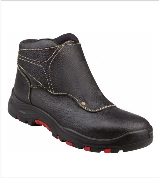
Chaussure haute avec rabat cuir croupon pigmenté doublure : polyester première de propreté : amovible prémoulée dessus polyamide sur EVA. semelle : Injectée - PU/caoutchouc nitrile piqûres para-aramide rabat de protection fermeture par bande agrippante tige : cuir croupon pigmenté, traité imperméable S3 protection contre les risques thermiques et les projections de grattons spécialement conçue pour toute activité de soudage multi-sectorielle.
