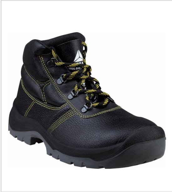
Tige : cuir croupon pigmenté doublure : Mesh polyamide première de propreté : amovible pré moulée dessus polyester sur EVA. semelle : Injectée PU bi-densité semelle et embout de protection acier inoxydable.
