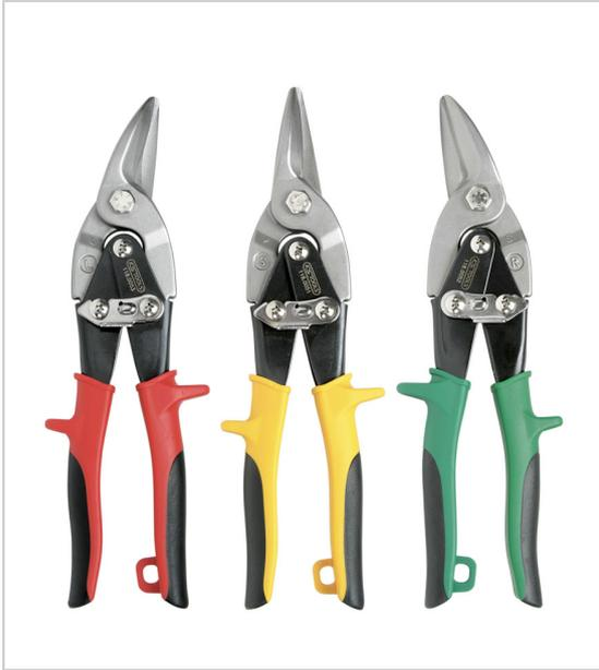
Ouverture automatique arrêt de verrouillage munie d'un trou d'accrochage lame durcie par induction poignée bi-matière coupe des tôles en acier jusqu'à Ø 1,25 mm coupe des tôles en acier inoxydable jusqu'à Ø 0,7 mm sens de coupe : 1 x à droite, 1 x droite; 1 x à gauche.
