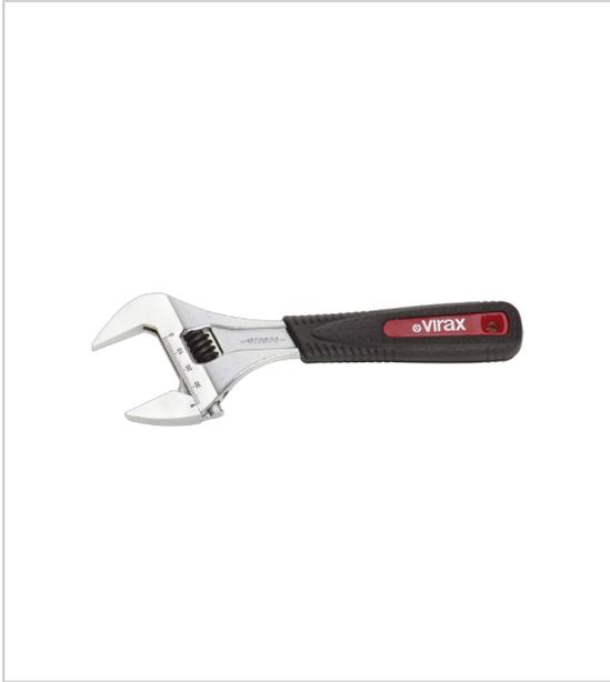
Mâchoire à grande ouverture résistance à la torsion permet de remplacer 3 clés à molette (6" -8" -10" pour 0151796, 8" -10" -12" pour 0017972) ergonomique : manche gainé antidérapant pour une meilleure prise en main pour les espaces restreints : épaisseur réduite des bouts de becs et mâchoire mobile non saillante en position ouverte.
