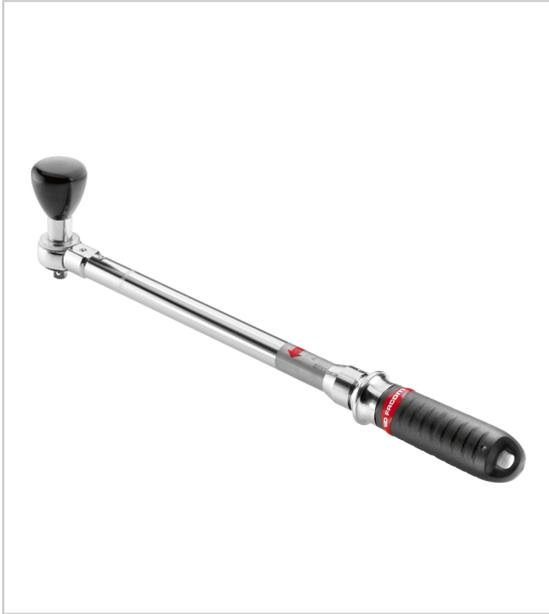
Précision : ±1 2% endurance du mécanisme : 50000 cycles clé mono-sens utilisable en desserrage par retournement des embouts clé numérotée livrée avec certificat d'étalonnage ISO 6789 cliquet mécanisme 72 dents pour une reprise de 5° livrée en boîte plastique avec cliquet.
