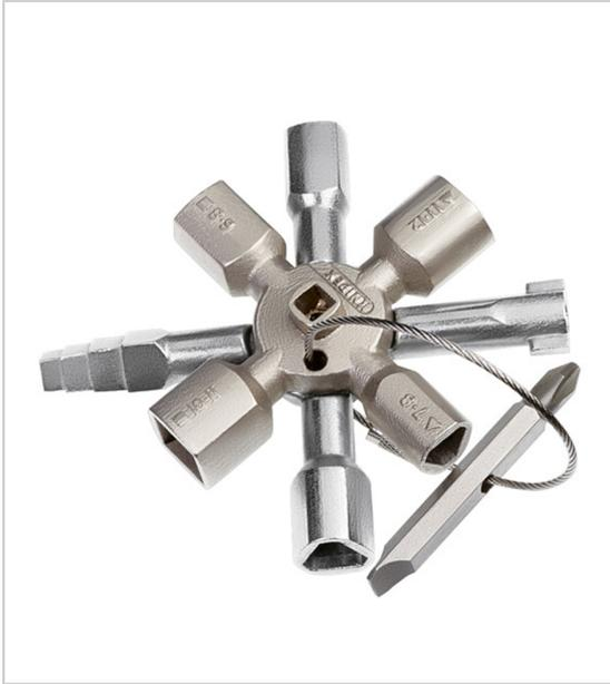
Pour l'actionnement des fermetures des zones techniques des bâtiments version à 8 clés : 2 clés cruciformes reliées au moyen d'aimants embout réversible : fente 1 x 7 mm et fente cruciforme PH2 clé et embout réversible accouplés par un fil en acier inoxydable construction en fonte de zinc sous pression capacité carré : 5/6-7/8-9/10-11 mm capacité triangle : 7-8/9-10/11-12 mm capacité queue de pic : 3-5 mm capacité carré étagé : 6-9 mm.
