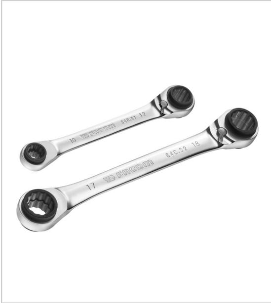
Jeu de 2 clés polygonales à cliquet droites multi-ouvertures (8 dimensions) : 8x10 - 12x13 - 16x17 - 18x19 mm mécanisme à cliquet compact et réversible par levier angle de reprise à 5° présentation : chromée satinée.
