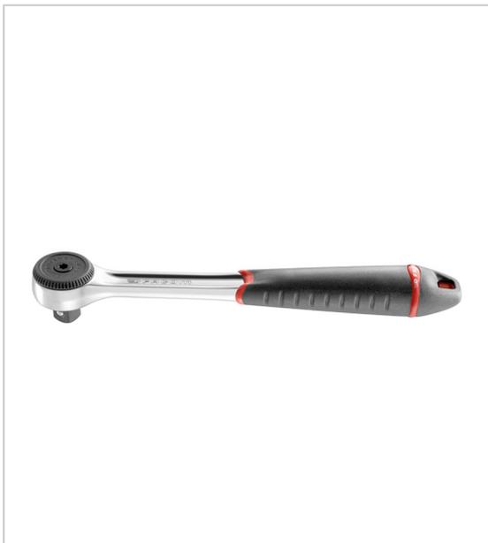
Très grande longévité étanche aux poussières industrielles mécanisme 72 dents pour une reprise à 5° inversion par chapeau rotatif tête ultra-compact poignée en élastomère bi-matière : forte résistance à l'abrasion et aux solvants d'atelier les plus sévères trou dans la poignée : permet l'accrochage pour le travail en hauteur entretien facile.
