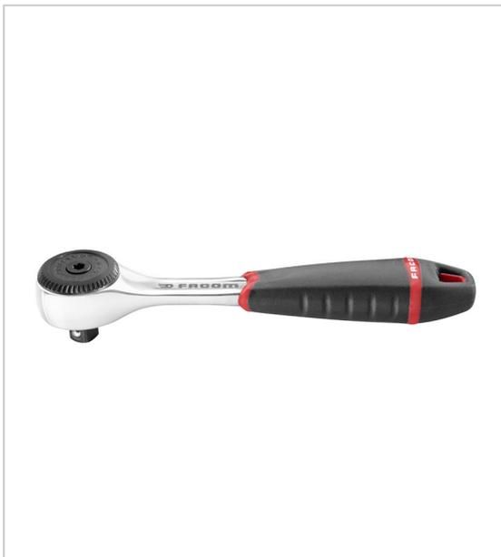
Etanche aux poussières industrielles mécanisme 72 dents pour une reprise à 5° inversion par chapeau rotatif tête ultra-compact poignée en élastomère bi-matière forte résistance à l'abrasion et aux solvants d'atelier les plus sévères trou dans la poignée : permet l'accrochage pour le travail en hauteur présentation : chromée brillante entretien facile : kit de pièces détachées R.161B-KIT.
