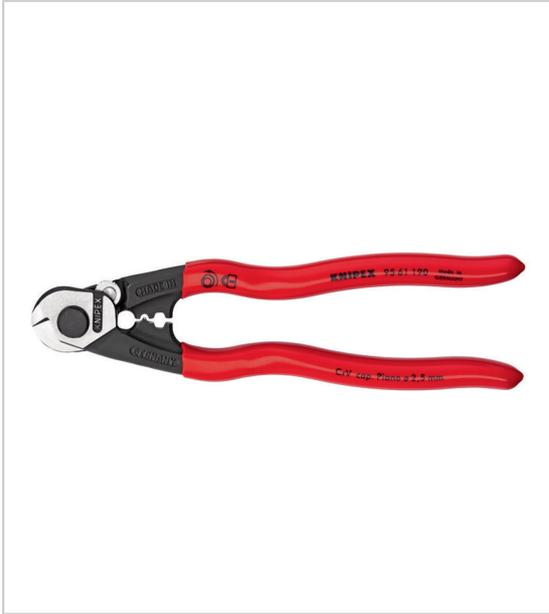
Forte démultiplication poignées gainées en plastique convient aux câbles métalliques, aciers ronds avec 2 profils de sertissage pour embouts sur gaine de câble Bowden et embouts pour câble de traction dureté des tranchants env. 64 HRC.
