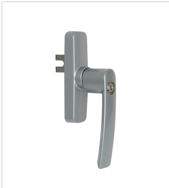
Corps et poignée en aluminium moulé sous pression, pignon et ressort en acier zingué, crémaillère en acier inox, plaquette inférieure en nylon.
