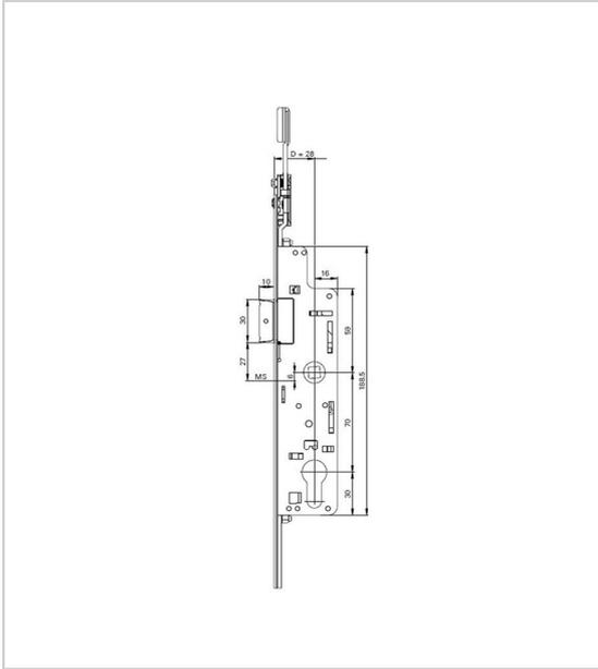
Crémone serrure H100 pour porte fenêtre, manoeuvre par relevage de béquille, condamnation au cylindre, sans sortie de tringle.
