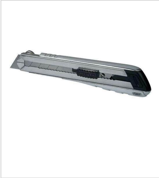
Corps aluminium léger, robuste et inoxydable bouton-poussoir pour un déverrouillage rapide de la lame cartouche de 4 lames à rechargement automatique casse-lames intégré aucun outil nécessaire pour le changement de lames molette de blocage : verrouillage total de la lame pendant l'utilisation poignée striée : bonne prise en main longueur : 210 mm fourni avec 4 lames de cutter 25 mm FATMAX.
