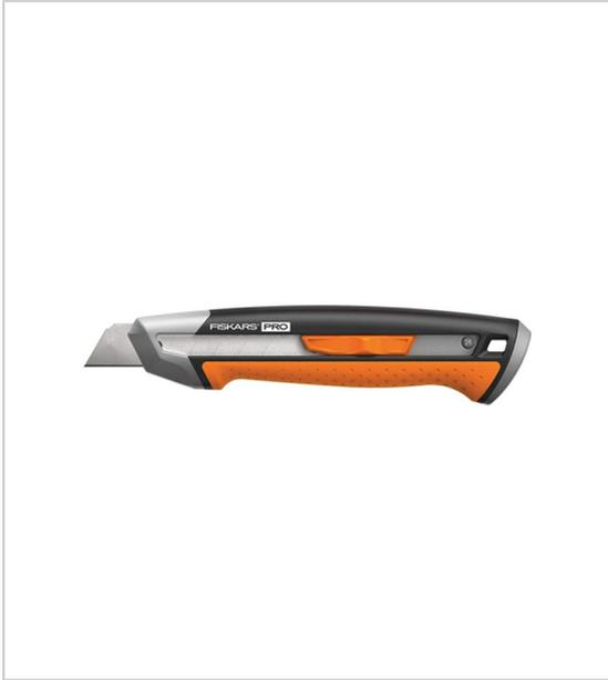
Cutter CarbonMax avec lames cassables 18mm permet un changement de lame facile avec son système de chargement frontal réservoir intégré permet de stocker les lames usagées, restent aiguisées 24 fois plus longtemps tandis que l'extrémité métallique permet une meilleure résistance aux chutes largeur 41 mm longueur 165 mm hauteur 24 mm.
