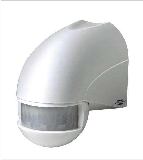
Utilisation intérieur et extérieur jusqu'à 12 m de distance environ durée de fonctionnement de 10 secondes jusqu'à 4 minutes environ puissance maxi 1000 W tête orientable en verticale et horizontale interrupteur crépusculaire à sensibilité réglable.
