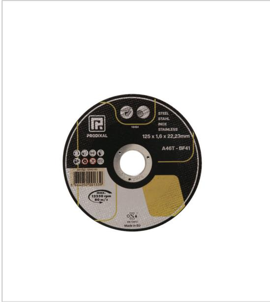
Disque à tronçonner, en résine organique bakélite et toile de renfort fibres de verre abrasif : oxyde d'aluminium découpe de toutes formes de pièces disque à tronçonner fins type 41 : à privilégier pour le tronçonnage de pièces fines disque plus épais type 42 : résiste davantage à l'échauffement et la pression matériaux pouvant être usinés : aciers Carbone et aciers Inoxydables boîte de 25.
