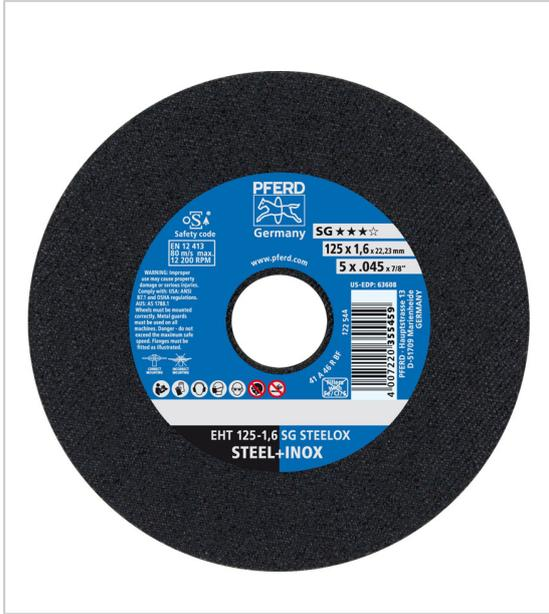
Outil de dureté R-INOX pour un tronçonnage sans échauffement rendement de tronçonnage élevé très bonne durée de vie abrasif : corindon A (fabriqué sans addition de produit de remplissage à teneur en fer, en chlore ou en soufre) matériaux pouvant être usinés : acier inoxydable (INOX) applications : tronçonnage de tôles, profilés et matériaux pleins boîte de 25.
