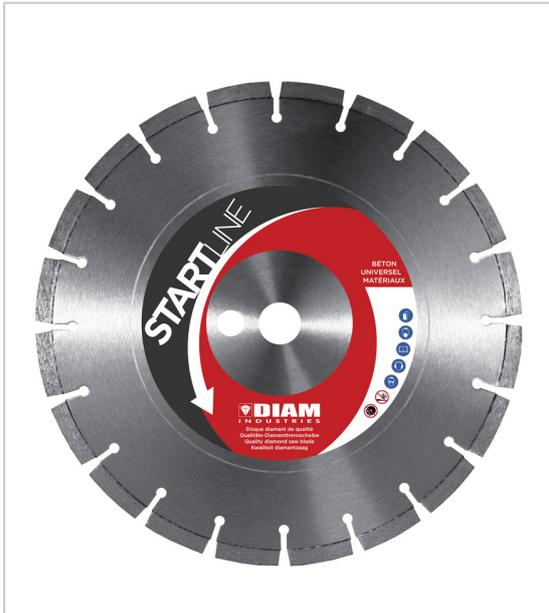
Matériaux: pour béton, béton armé, brique, parpaing. tôle renforcée permettant une meilleure rigidité lors des coupes, encoches "gouttes d'eau", coupe à sec.
