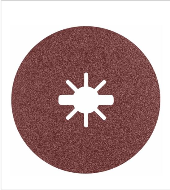
Abrasif oxyde d'alumine/céramique support fibre liant : résine synthétique épandage électrostatique coupe froide, performance de coupe homogène, grande durée de vie et bonne qualité de finition, vitesse d'enlèvement très élevée pour l'arasage de cordon de soudure, décalaminage, satinage, enlèvement de coloration... matériaux usinables: aciers non alliés ou faiblement alliés, acier hautement alliés vendu par 25.
