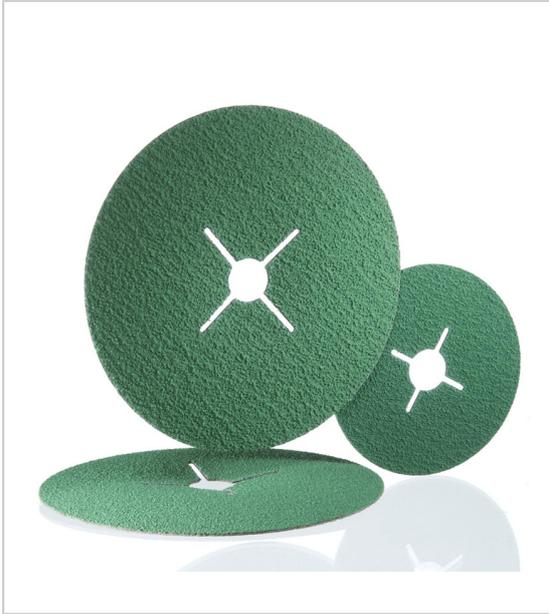
Abrasif céramique à haut pouvoir tranchant support fibre x distribution fermée haut pouvoir d'enlèvement résine PROCUT additionnelle pour réduction de la température lors du ponçage longue durée de vie support fibre très rigide et stable pour travaux d'ébavurage, ponçage des cordons de soudure, nettoyage et enlèvement de la rouille, ponçage des vieilles couches de peinture, réparation des tôles dimensions : Ø 125 x 22 mm boîte de 25.
