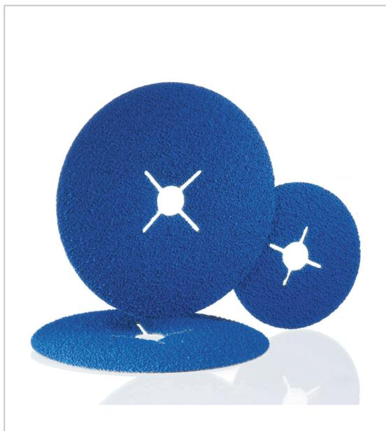
Abrasif zirconium support fibre X distribution fermée haut pouvoir d'enlèvement alésage 22 mm couche de résine PROCUT additionnelle pour limitation de la température de ponçage recommandé tout spécialement pour l'acier inox pour travaux d'ébavurage, ponçage des cordons de soudure, nettoyage de la rouille, ponçage des veilles couches de peinture boîte de 25.
