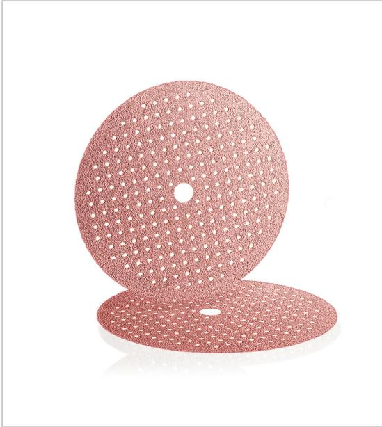
Disque papier auto-agrippant abrasif corindon structure ouverte pour ponçage des murs et des plafonds perçage multitrous s'adapte à toutes les machines "Girafe" gr 40 à 60 : support papier D, dos velours gr 80 et +: support papier C, dos velours boîte de 50.
